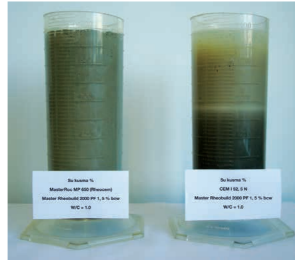
Stabil (solda) ve stabil olmayan (sağda) harç
