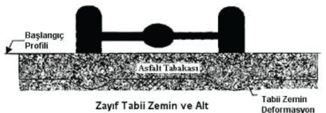
Şekil 2. Zayıf Bitümlü Tabakaya Bağlı Tekerek İzi Oluşumu
